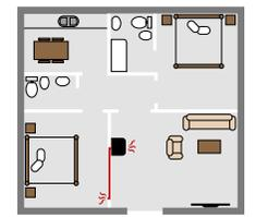
BIS ZU 8 METER WARMLUFTKANALISATION über 1 Ausgang hinten oder an der Seite links Ø80 (ausschließbar)
